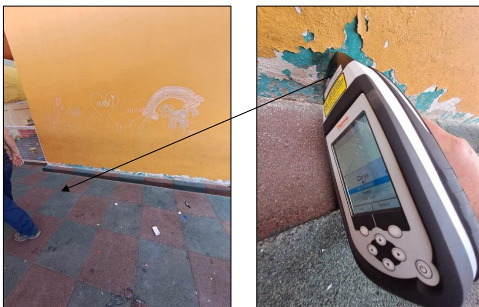
Imagen 10 y 11: Pintura con crisotilo descascarada en patio de juegos, jardín JUNJI, espectrómetro NIR.
