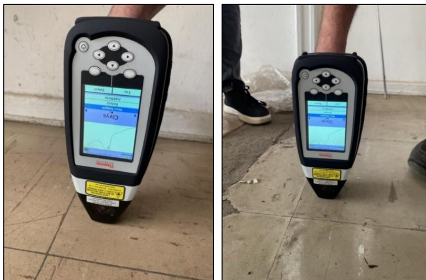
Imagen 17 y 18: Espectrómetro NIR sobre dos pavimentos distintos.
